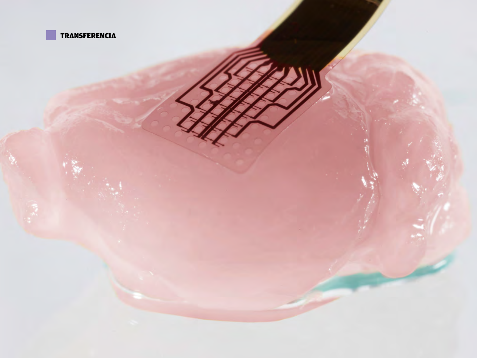
Composición simulada donde se refleja la adaptación de una interfaz neuronal basada en transistores de grafeno con las circunvoluciones cerebrales. / INBRAIN
