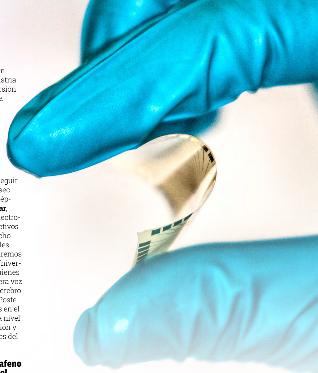
Ejemplo de la flexibilidad de los sustratos y materiales para fabricar interfaces neuronales con tecnología microelectrónica. / INBRAIN
