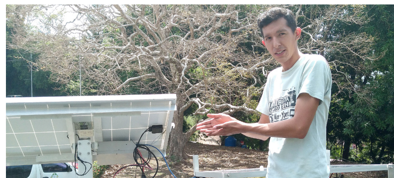
Agustín Orros explica que a medida que el sol se mueve el panel rota buscando su posición. Fotos: Cortesía de la Estación de Meteorología
